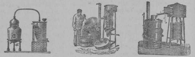
Alambique de vapor fijo ó basculante para Licores, Perfumes y Extractos
