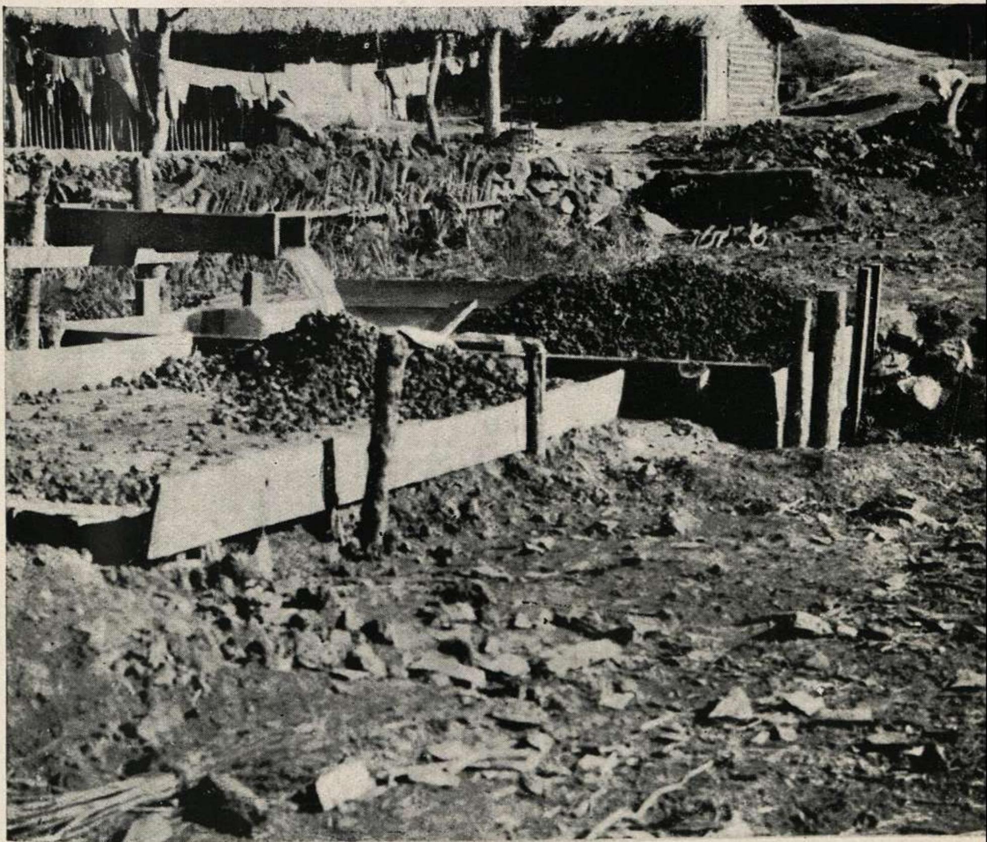
Foto 5 — Lavadouro retangular para as concreções manganésíferas de alto teor
