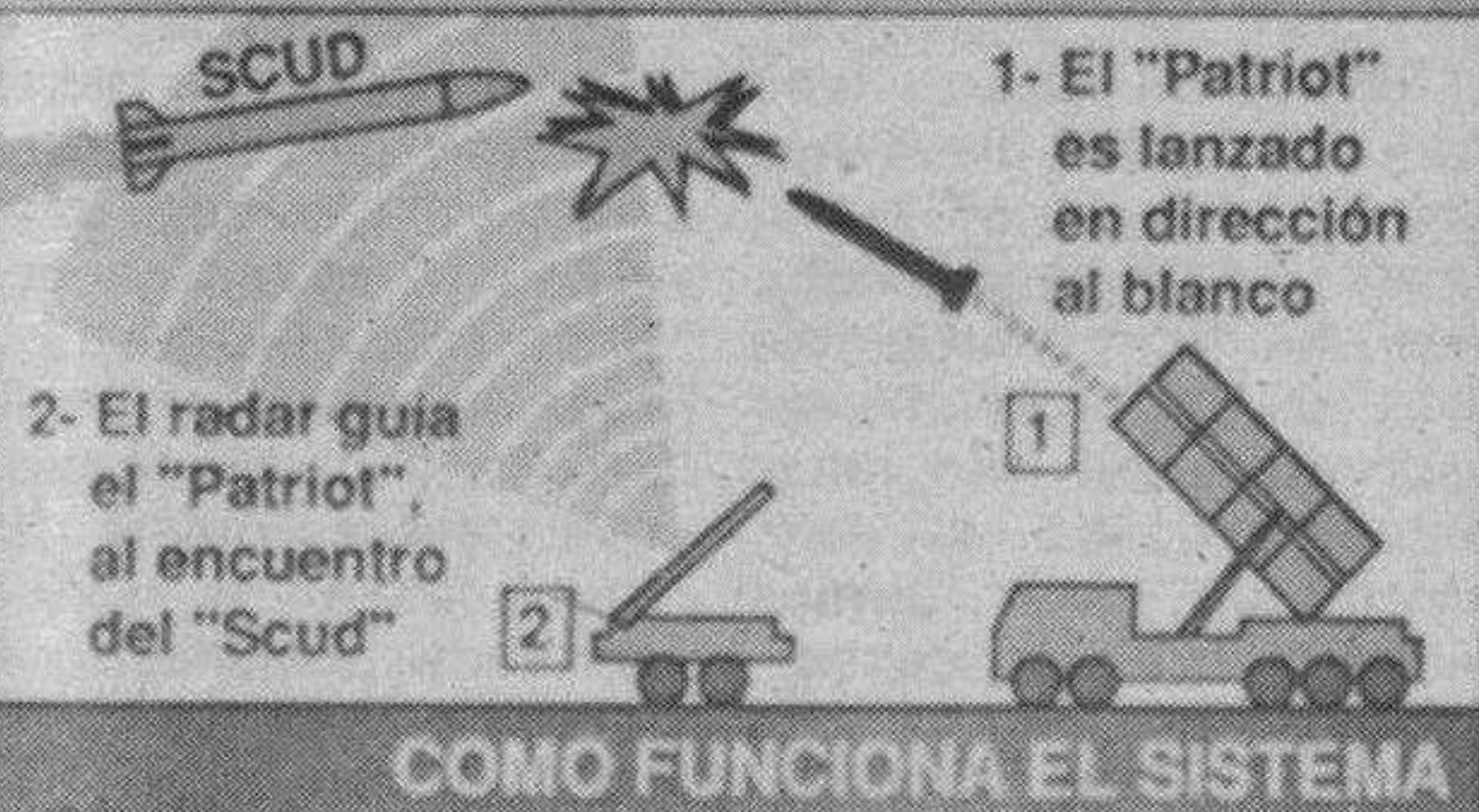
Esquema del sistema de defensa contra ataques aéreos «Patriot». Telefoto Efe.
