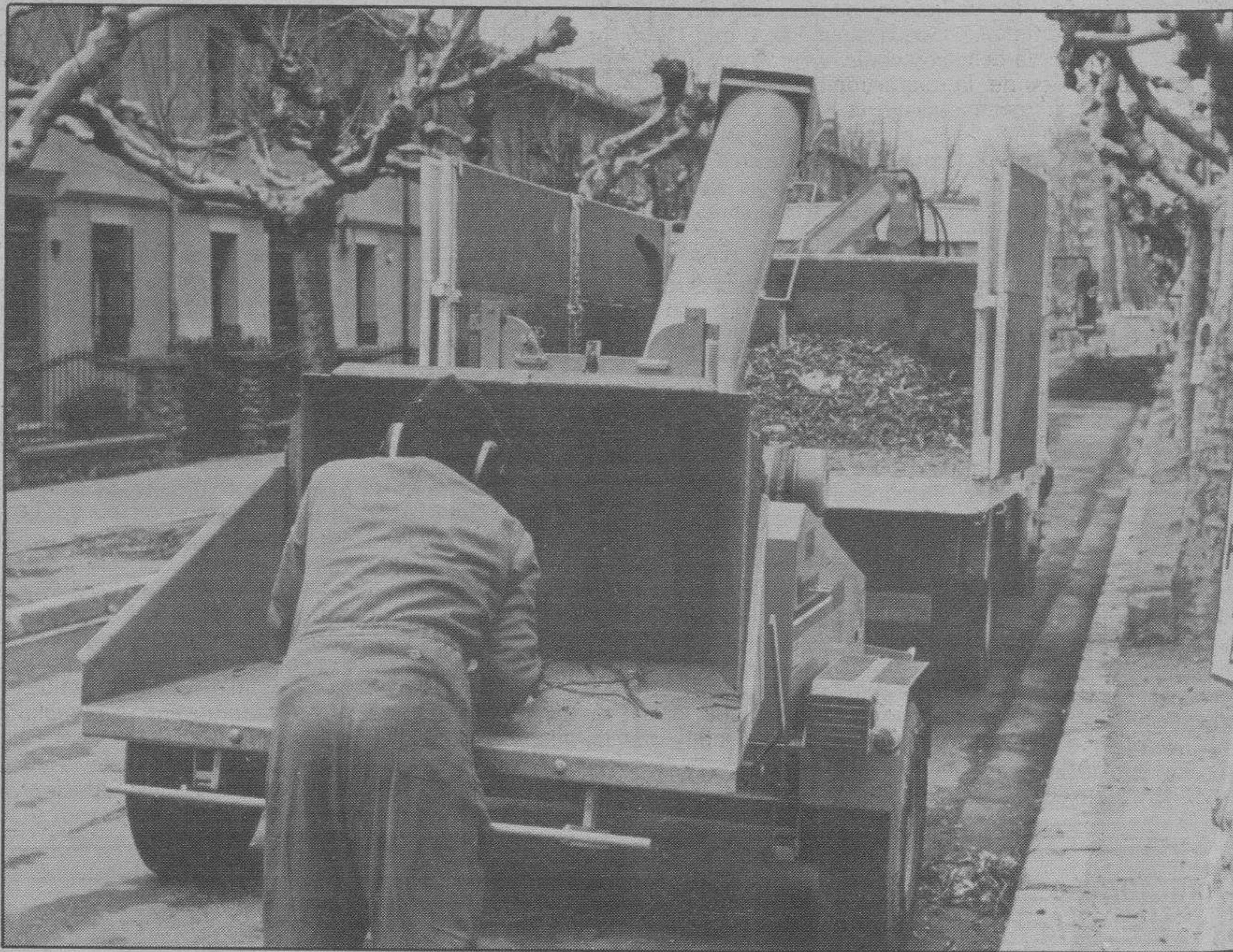
Trituradora de ramas. — Cada vez se mecaniza más el trabajo. Esta es una muestra. Antes, en tiempos de poda de los árboles, había que hacer el transporte en camiones con mucho volumen y poco peso. Ahora se utiliza la trituradora que convierte en viruta en pocos segundos las ramas que han sido cortadas. El funcionamiento ha causado curiosidad en la vía pública. Es tremendamente eficaz. Mejoras de estas son interesantes.
