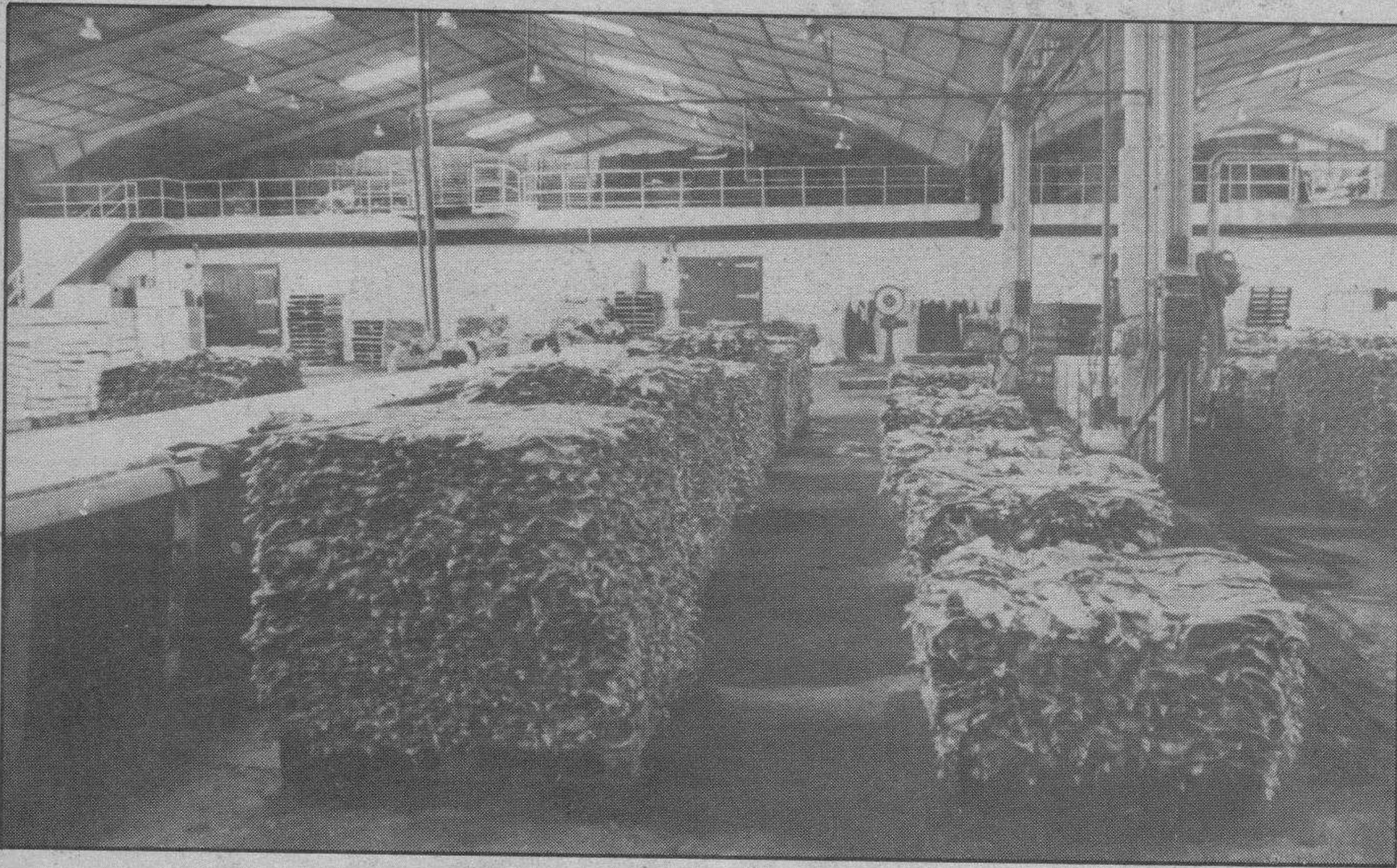
Pilas de colas de bacalao, tras ser lavadas y saladas (el lavadero está a la izquierda), dispuestas para ser introducidas en los túneles de secado
