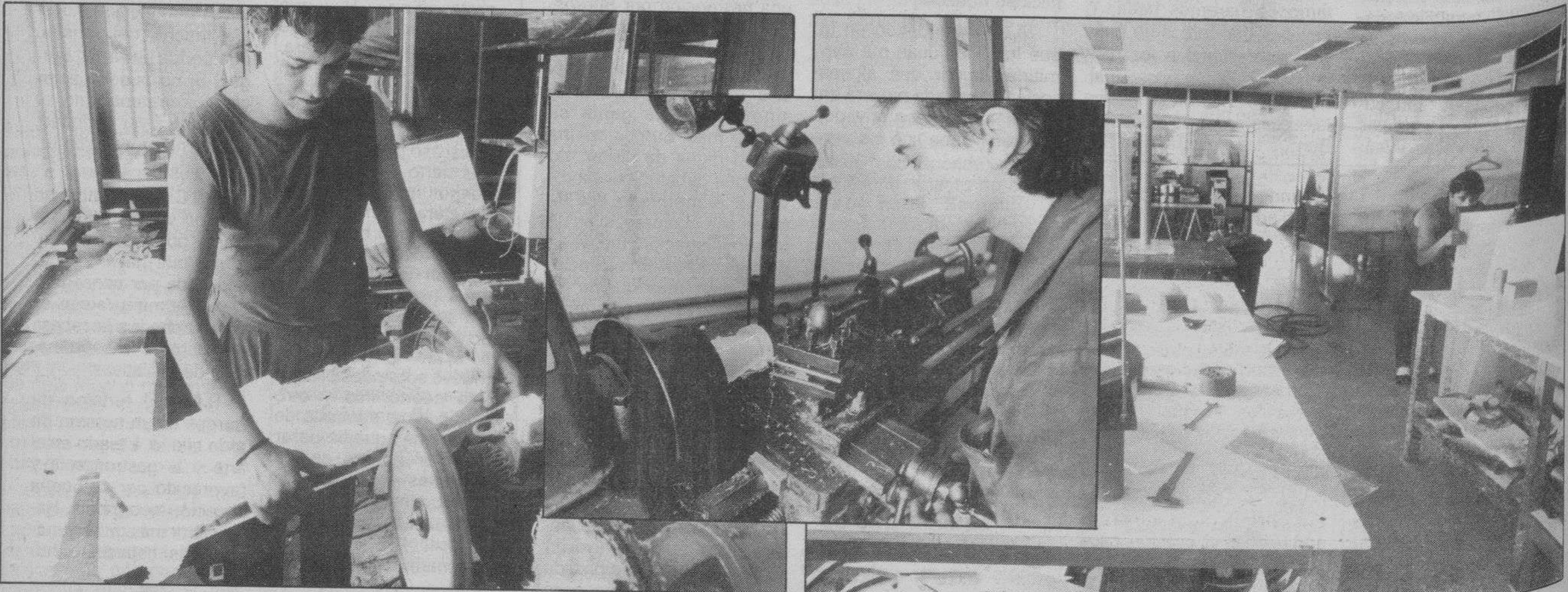
La manipulación del plástico comienza con el corte, proceso que se completa en otras secciones, de moldeo térmico, mecanizado, plegado, pulido, etc.
