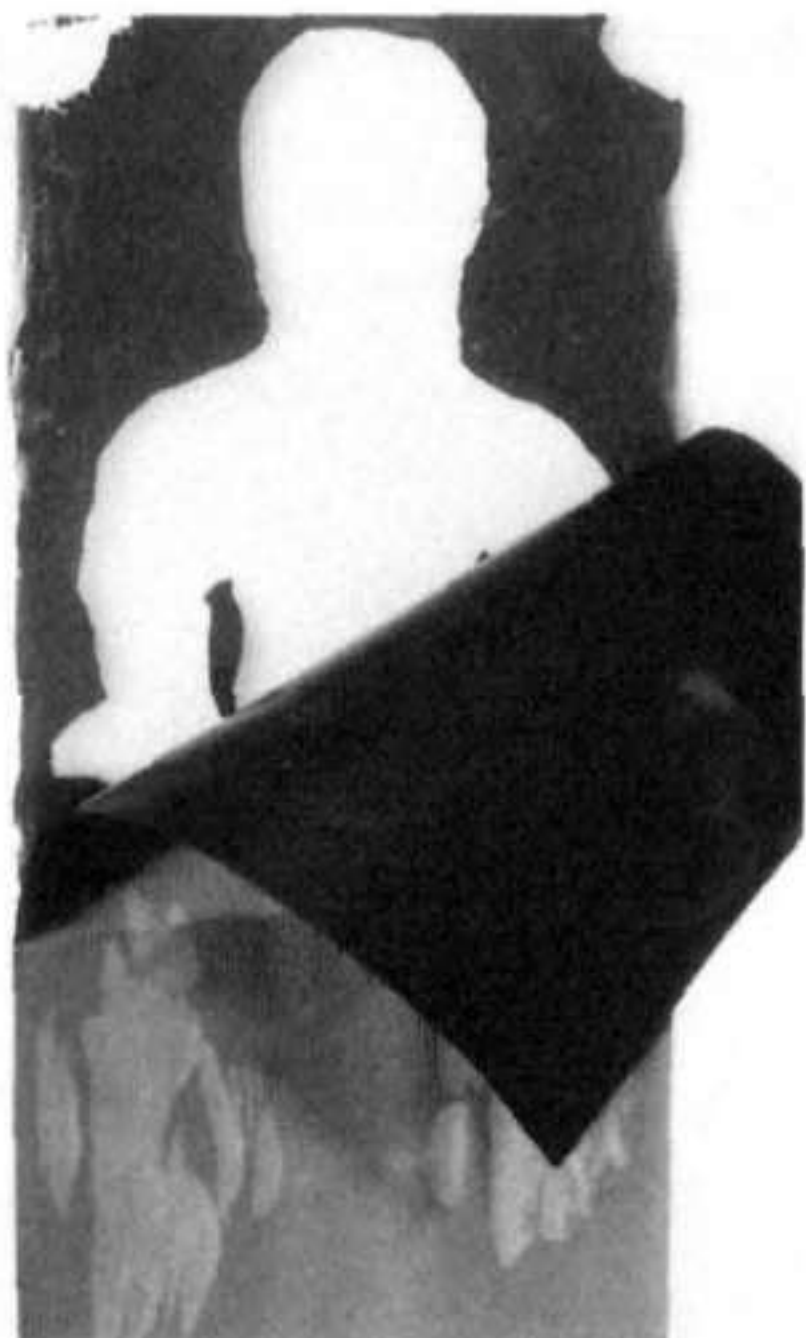
EN LA FOTOGRAFÍA SE APRECIA LA SEPARACIÓN ENTRE SOPORTE Y EMULSIÓN EN UN NEGATIVO SOBRE ACETATO.
