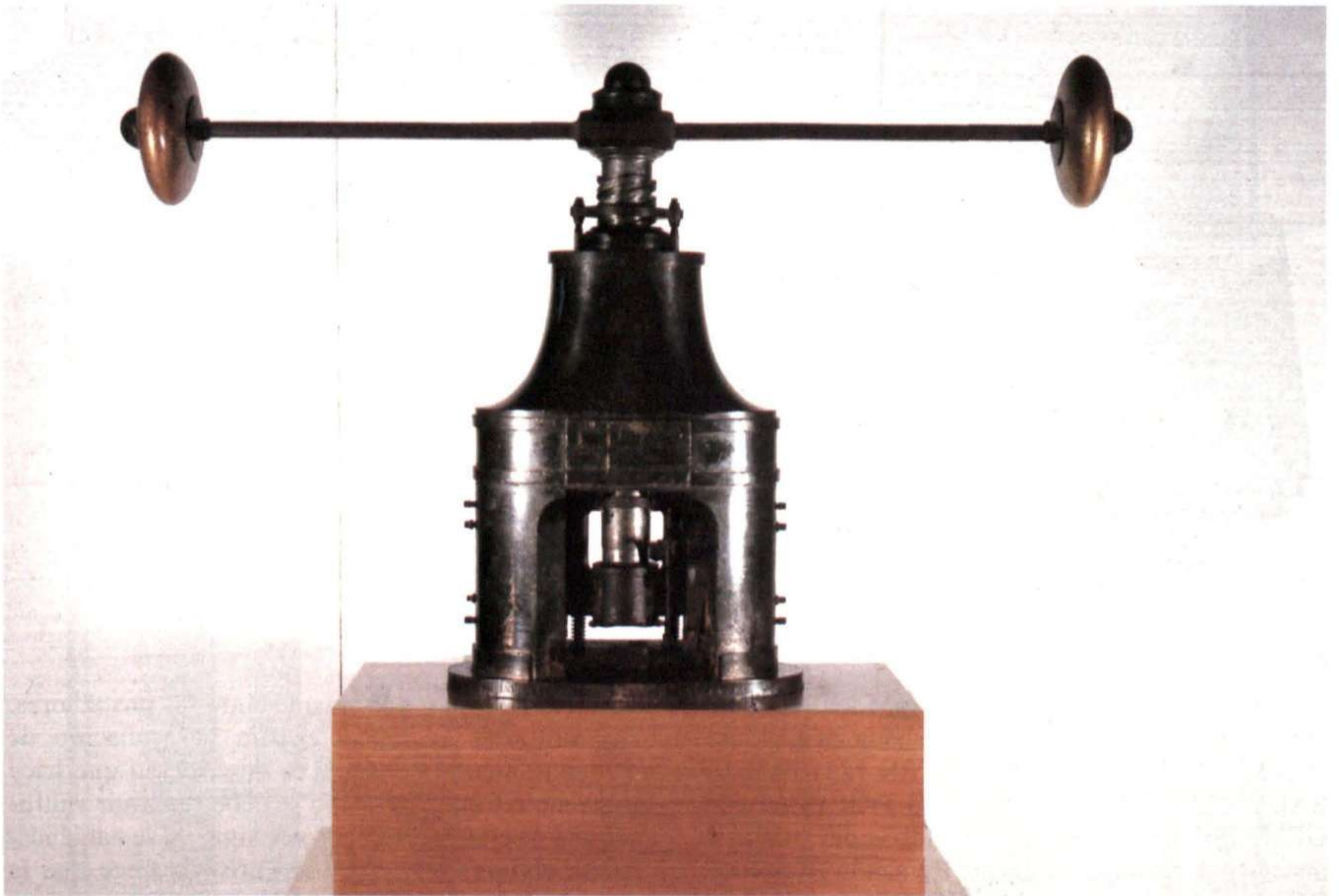
Figura 4: Prensa de volante conservada en el M.A.N., adquirida por la Casa de la Moneda de Madrid en la primera mitad del siglo XIX. (Foto M.A.N.)
