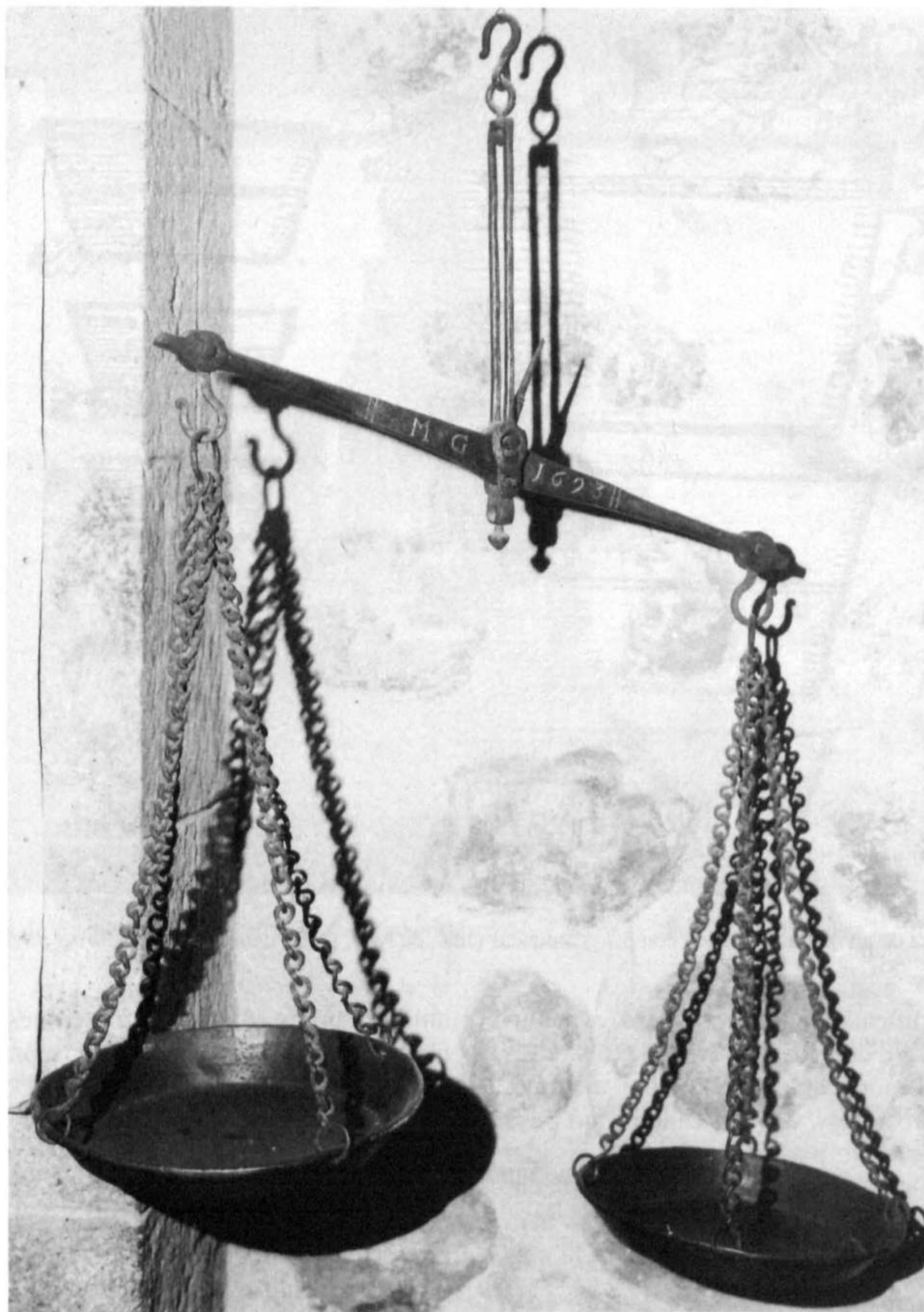
Figura 2: Balanzas de brazos iguales conservadas en la antigua Casa de Moneda de Potosí (Bolivia). (Foto: Glenn Murray)
