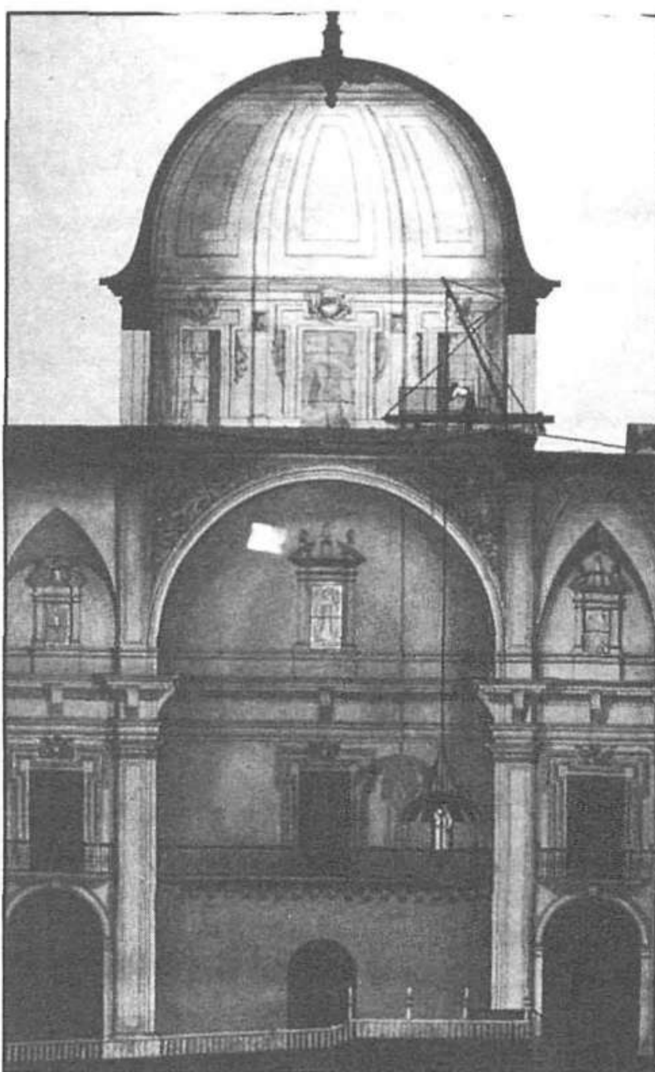
Arriba, sección del crucero de Santa María realizado por Coquillat. Abajo, dibujo de Antoni Serrano que ilustra la instalación de las tramoyas aéreas.
