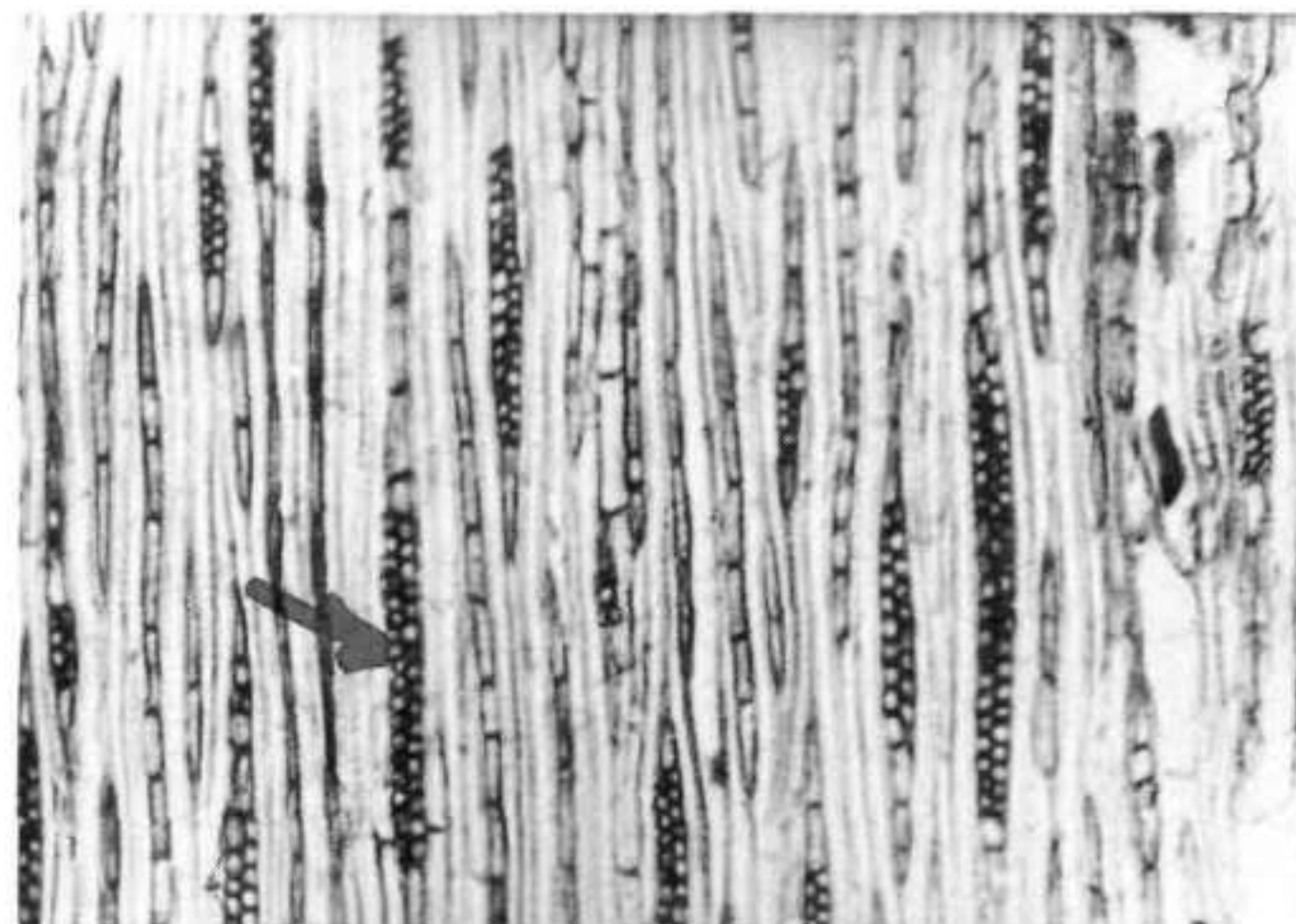
SECCIÓN TANGENCIAL DE LA MADERA DE ALNUS JORULLENSIS . RADIOS UNISERIADOS. (CORTE ANATÓMICO CON ORIENTACIÓN DEFICIENTE.)
