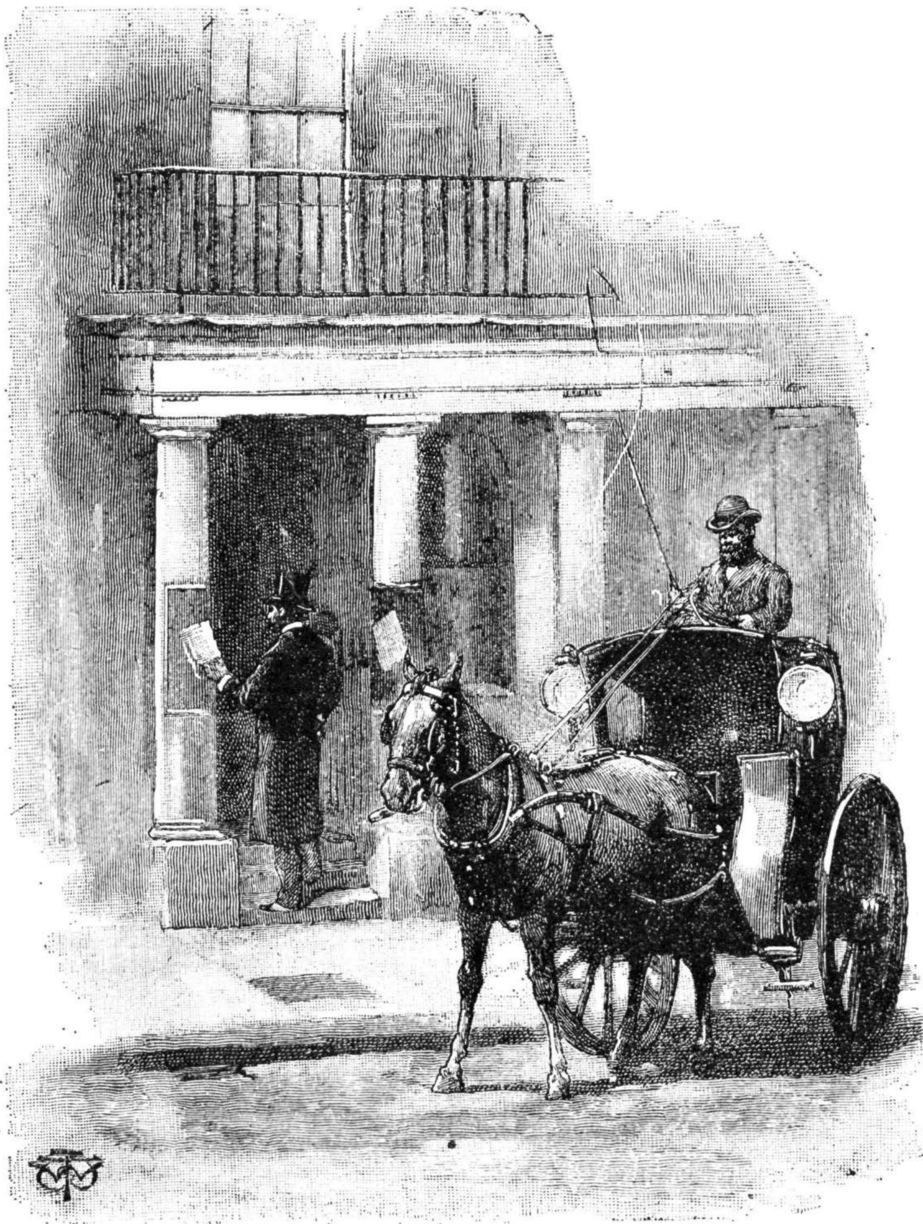
Versión inglesa de un cabriolé (muy difundido en el siglo XIX) de dos ruedas, con pescante alto y atrás. Disposición discriminatoria, separadora entre los ocupantes y el cochero, heredada en realidad de la carroza, pero que al ser reproducido este grabado en «La Ilustración Ibérica» decía en su pie irónicamente: «Vemos aquí el cab inglés, emblema del carácter de aquellos encopetados insulares que no pueden consentir que se les ponga el cochero delante de su persona.» El grabado reproduce una calle de Londres. El caballero ha bajado del coche para consultar las listas expuestas a la entrada del edificio
