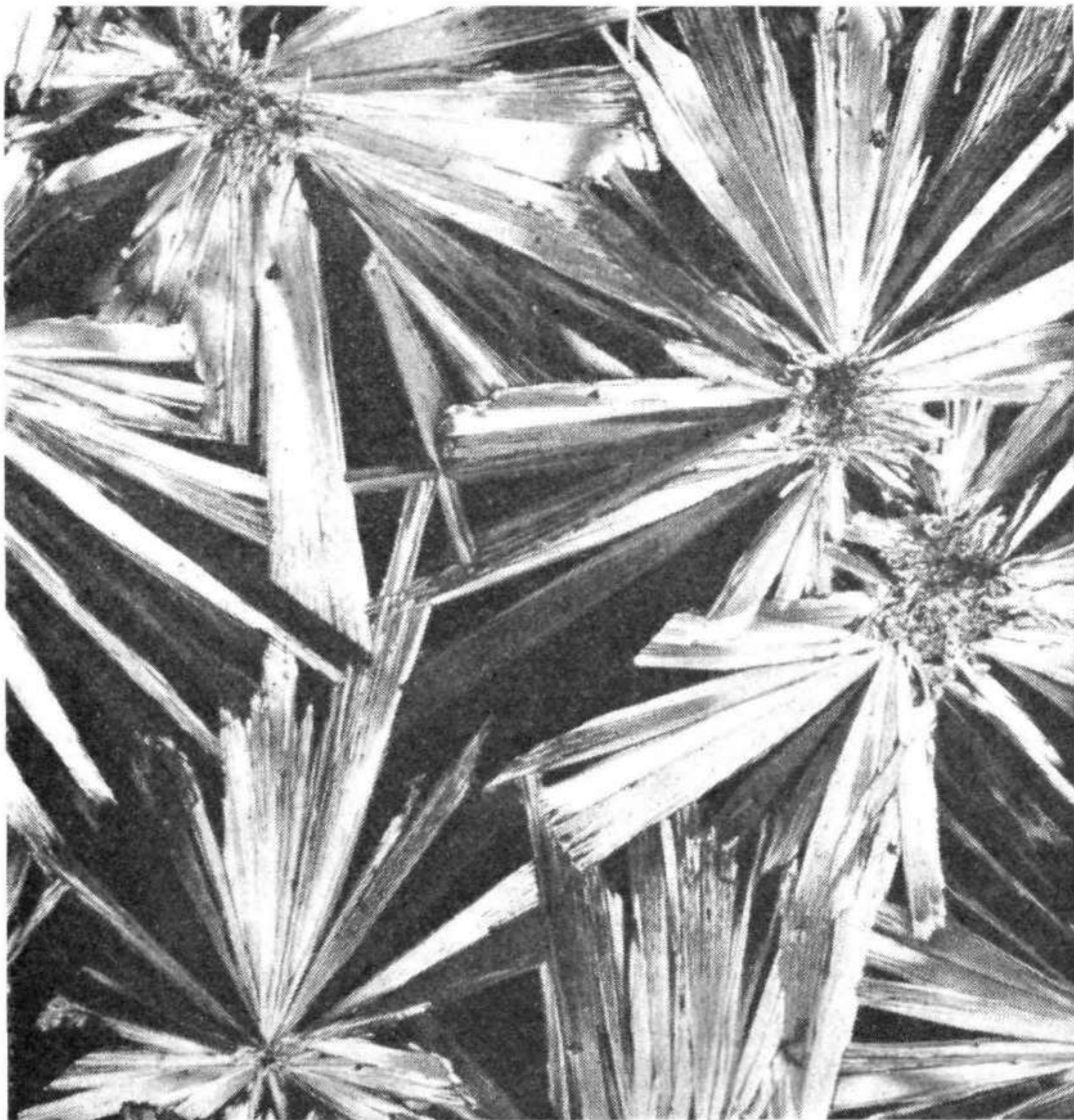
El microscopio electrónico descubre esta organización en «estrella» del acetato de magnesio
