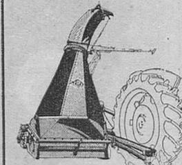
Cosechador para toda clase de forrajes, incluso para los más densos. El acoplamiento lateral y dispone de enganche para el arrastre del remolque.
