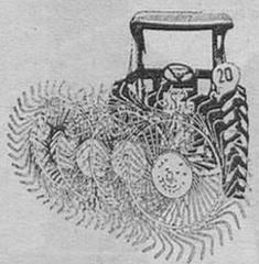
"ZAGAHENE" Rastrillo hilerador-volteador provisto de 4 discos autoadaptables a las irregularidades del terreno. Anchura de labor, 2 m. aprox.
