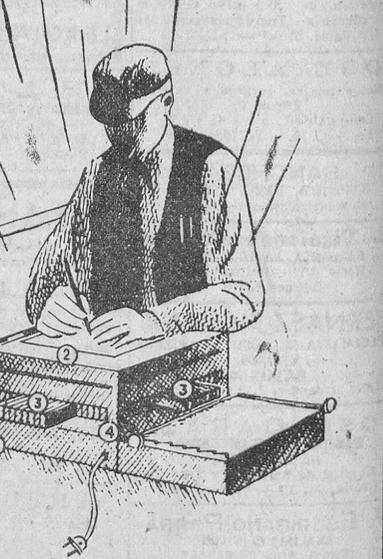
MAQUINA "FISCHOF" Seleccionadora de escritura. 1) Caja para contener fotografías. 2) Placa de cristal para el trazado de los rasgos. 3) Piezas móviles seleccionadoras. 4) Doble cristal para contener los documentos. 5) Base iluminada.
