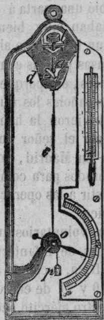
Fig. 1.ª. — Higrómetro de absorción.
