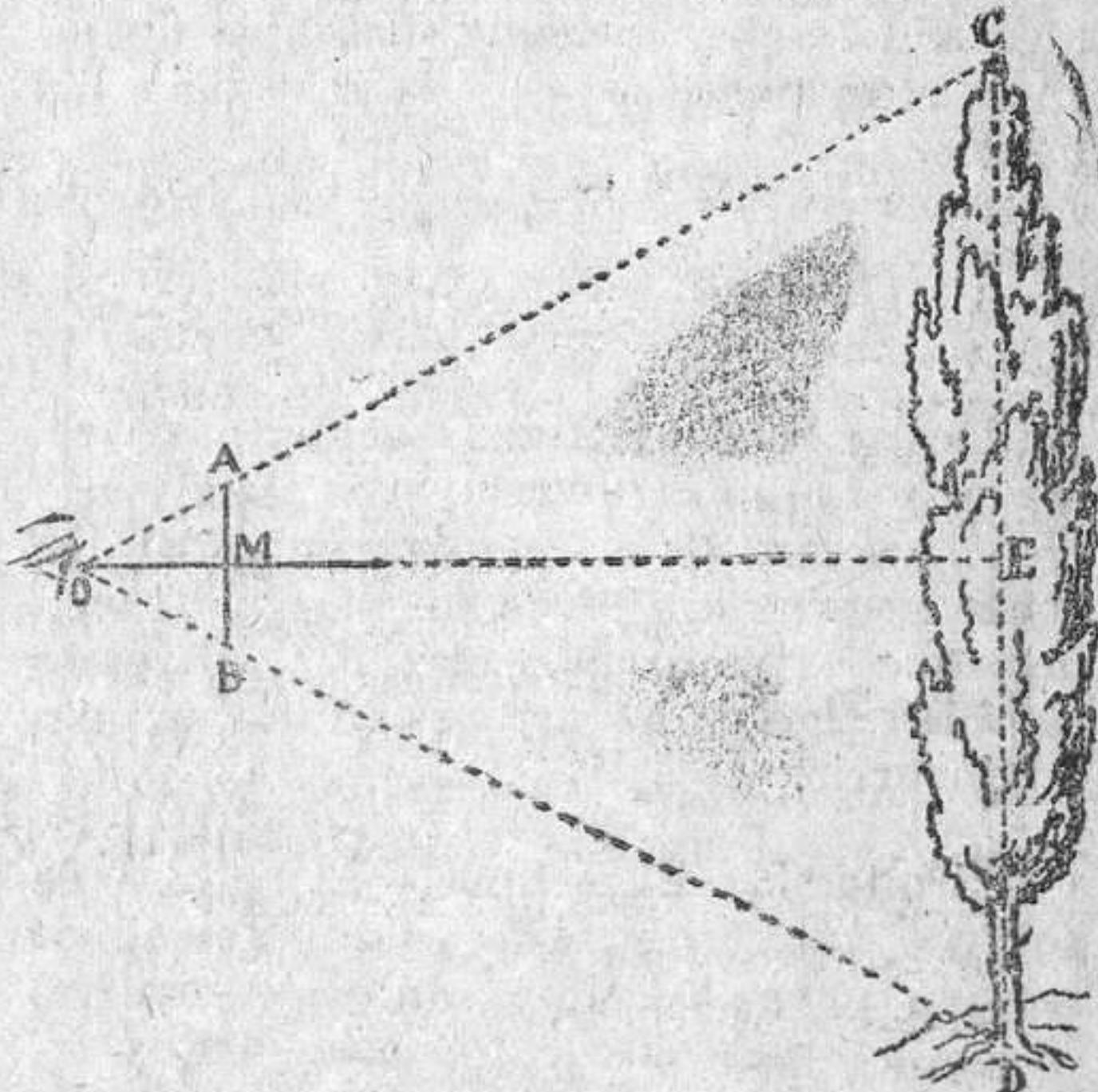
*Taquímetro elemental:* OM, listón largo dividido en centímetro; AB, listón corto de 20 cm.; O E, distancia al árbol que debe medirse sobre el suelo; CD, altura del árbol; los triángulos OAB y OCD son semejantes.
