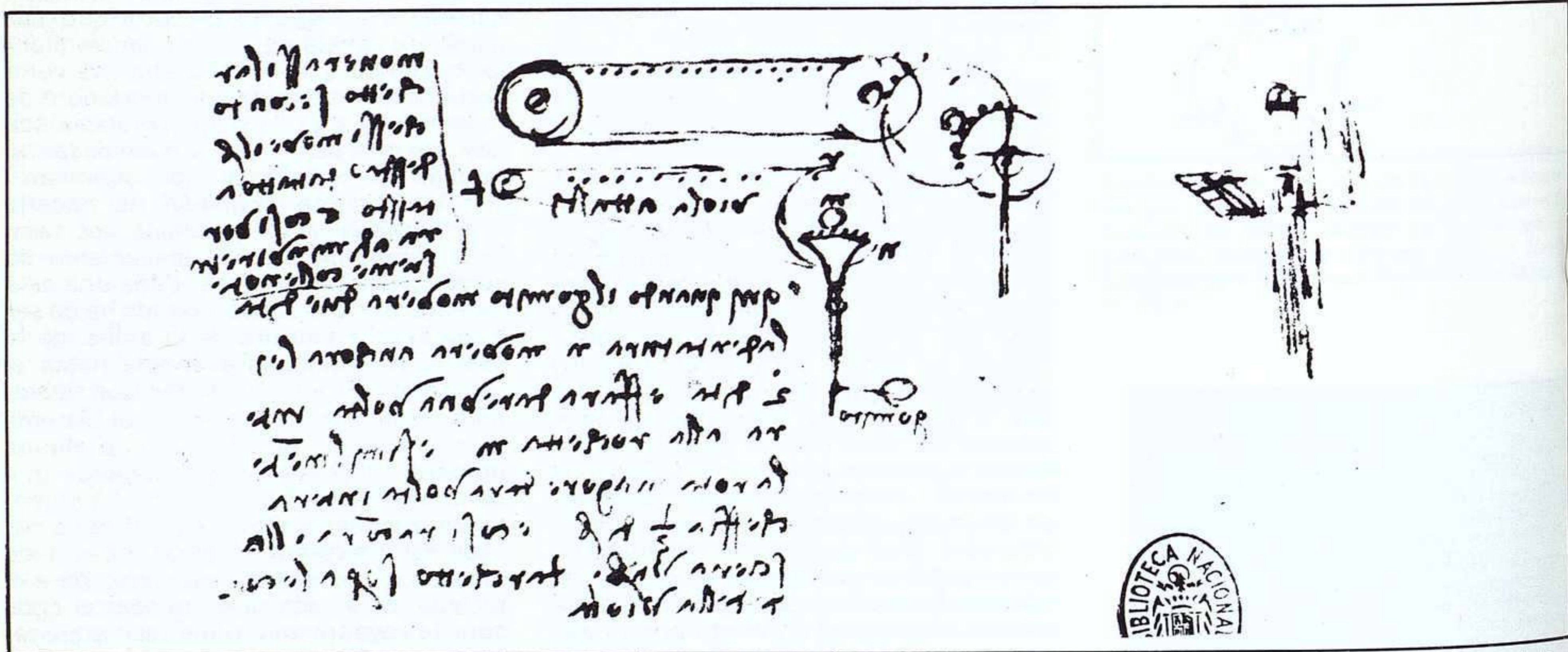
Estudio de mecanismo para poder lograr un «arco sin fin» con el que tocar la «viola organista». El «archetto» se comporta como una cinta transportadora, permaneciendo siempre en movimiento. Códices de la Biblioteca Nacional de Madrid, II, 75 r.
