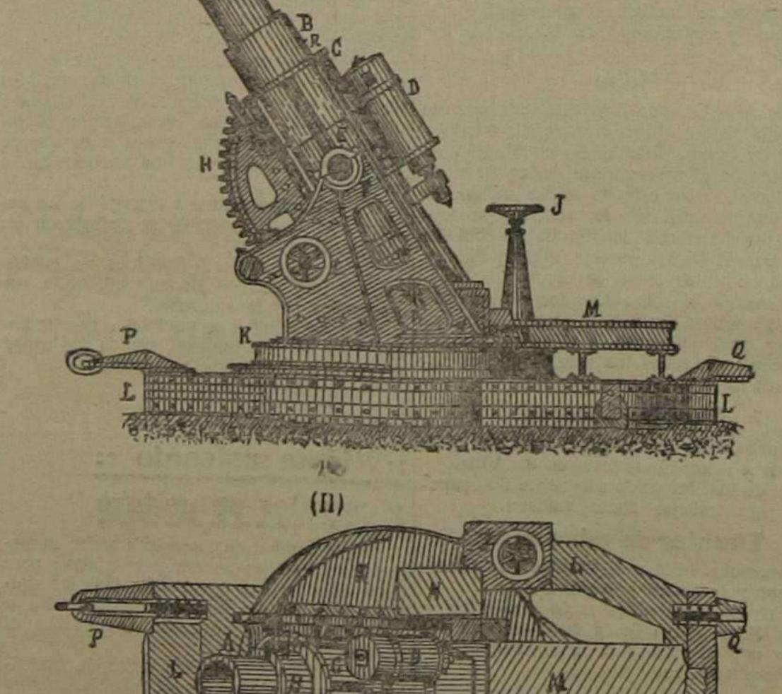
Figura 16. - Mortero austriaco de sitio, de 30'5 centimetros, sistema
