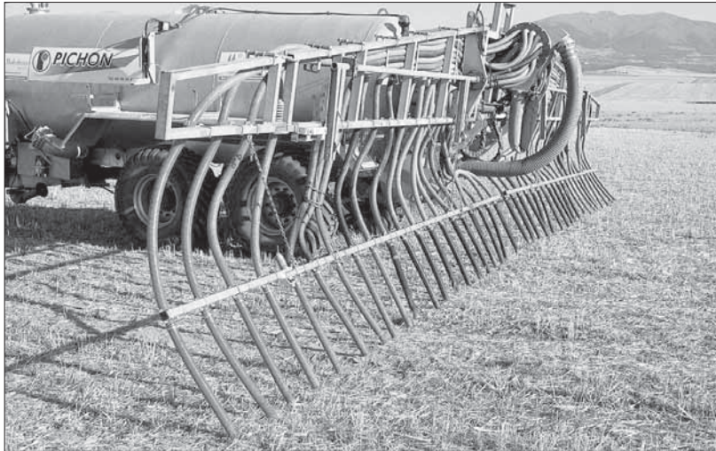
Una de las máquinas utilizadas para inyectar los purines en el suelo y usarlo como fertilizante EL ADELANTADO
