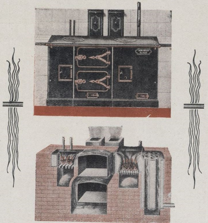
Disposición Interior de la cocina (alzado)
