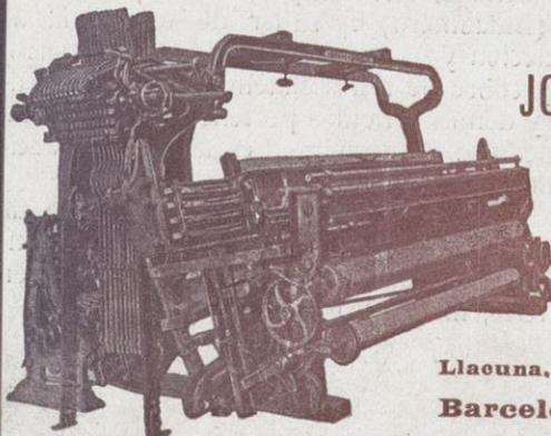
Telar especial para la fabricación de Paños y Novedades de 240 cm., luz de púa y a los anchos que se deseen. Telar de manivela. Maquinaria especial para la preparación del arte textil
