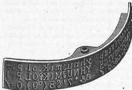
Fig. 4. - Lanzadera de tipos
