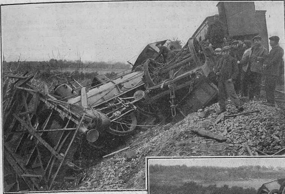
La máquina, el tender y el vagón jaula causa del descarrilamiento.
