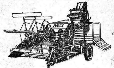
Cosechadoras de Arrastre con toma de fuerza o motor auxiliar "JUBUS" C. J. 150 y C. J. 180. Anchuras de corte 1,50 y 1,80 mts.
