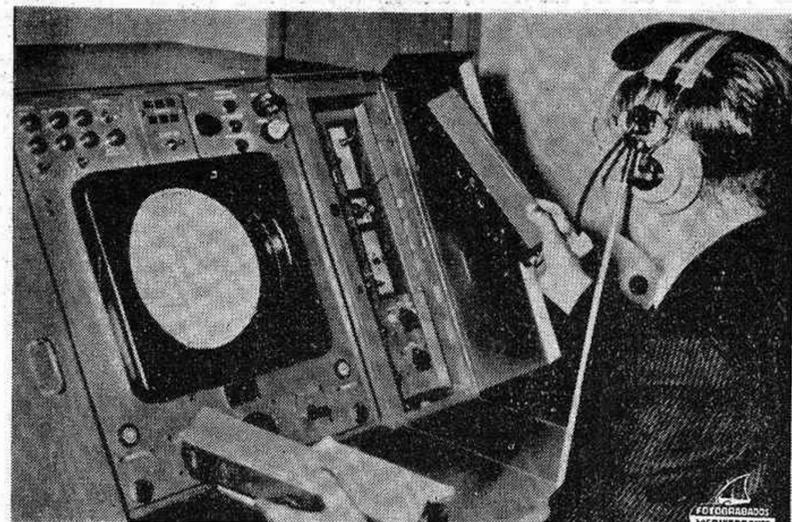
La invención consiste en un avisador complementario para equipos de radar, de aplicación preferente como sistema de seguridad para la navegación marítima. Constituye, por sí, un «operador» de radar de máxima experiencia en la interpretación de la pantalla, para el que no cabe distracción posible, ni fatiga y para el que no son obstáculos las deficiencias del radar ante las condiciones meteorológicas adversas.
