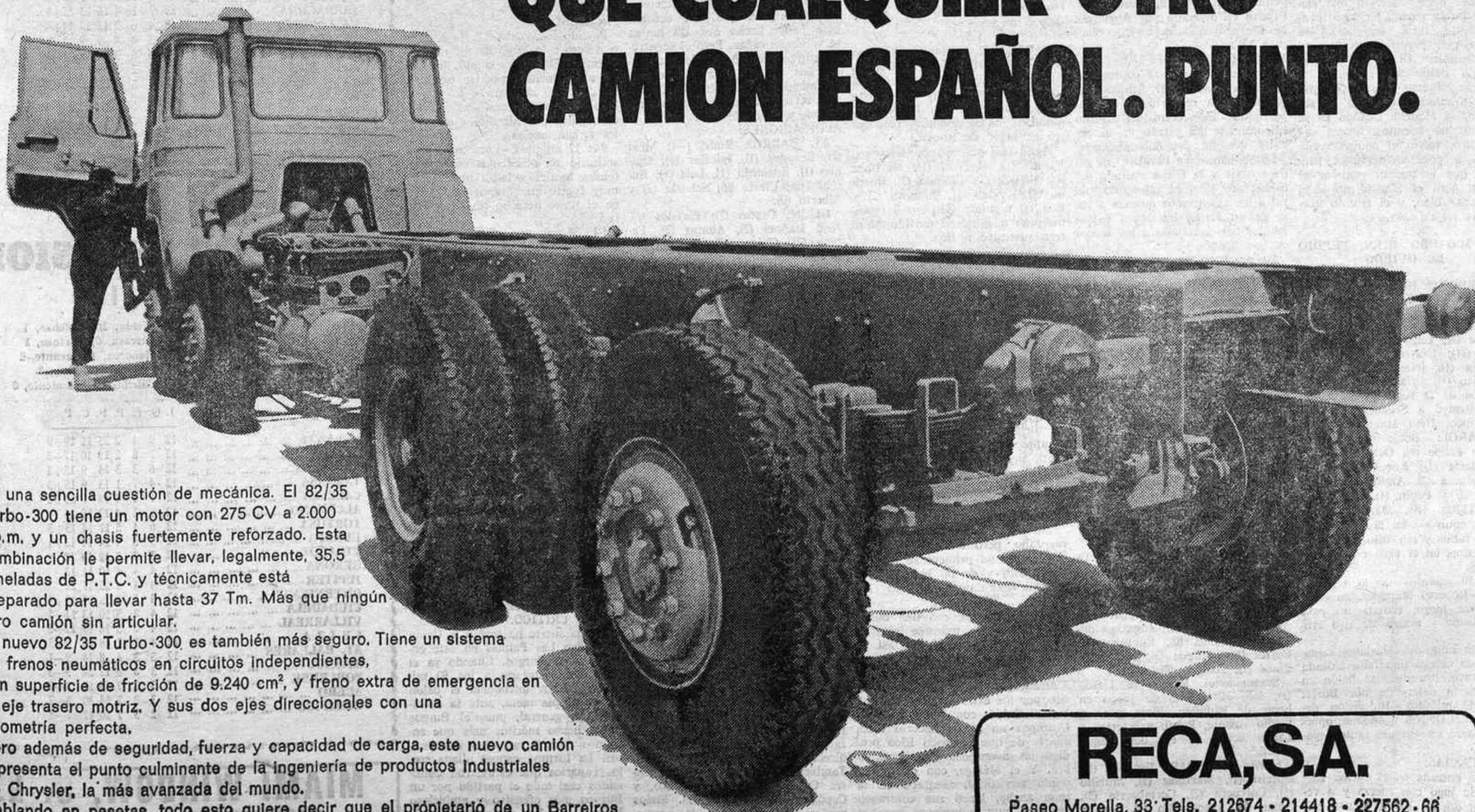
Es una sencilla cuestión de mecánica. El 82/35 Turbo-300 tiene un motor con 275 CV a 2.000 r.p.m. y un chasis fuertemente reforzado. Esta combinación le permite llevar, legalmente, 35,5 toneladas de P.T.C. y técnicamente está preparado para llevar hasta 37 Tm. Más que ningún otro camión sin articular.
