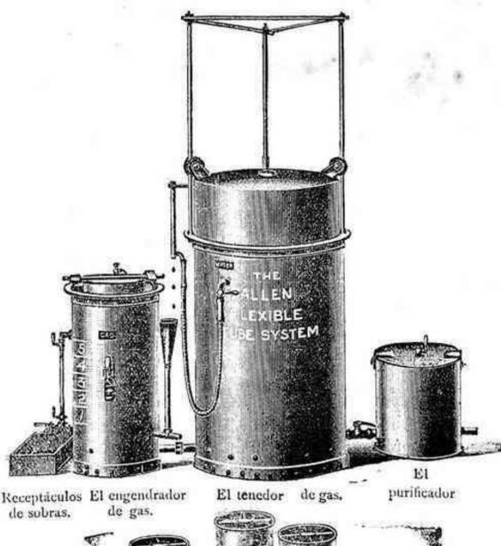
EN el presente grabado el tenedor de gas está representado en su condición baja al lugar donde el agua se derrama del Tubo flexible en el embudo que comunica con el compartimiento que contiene el "Carbido" con el gas.
