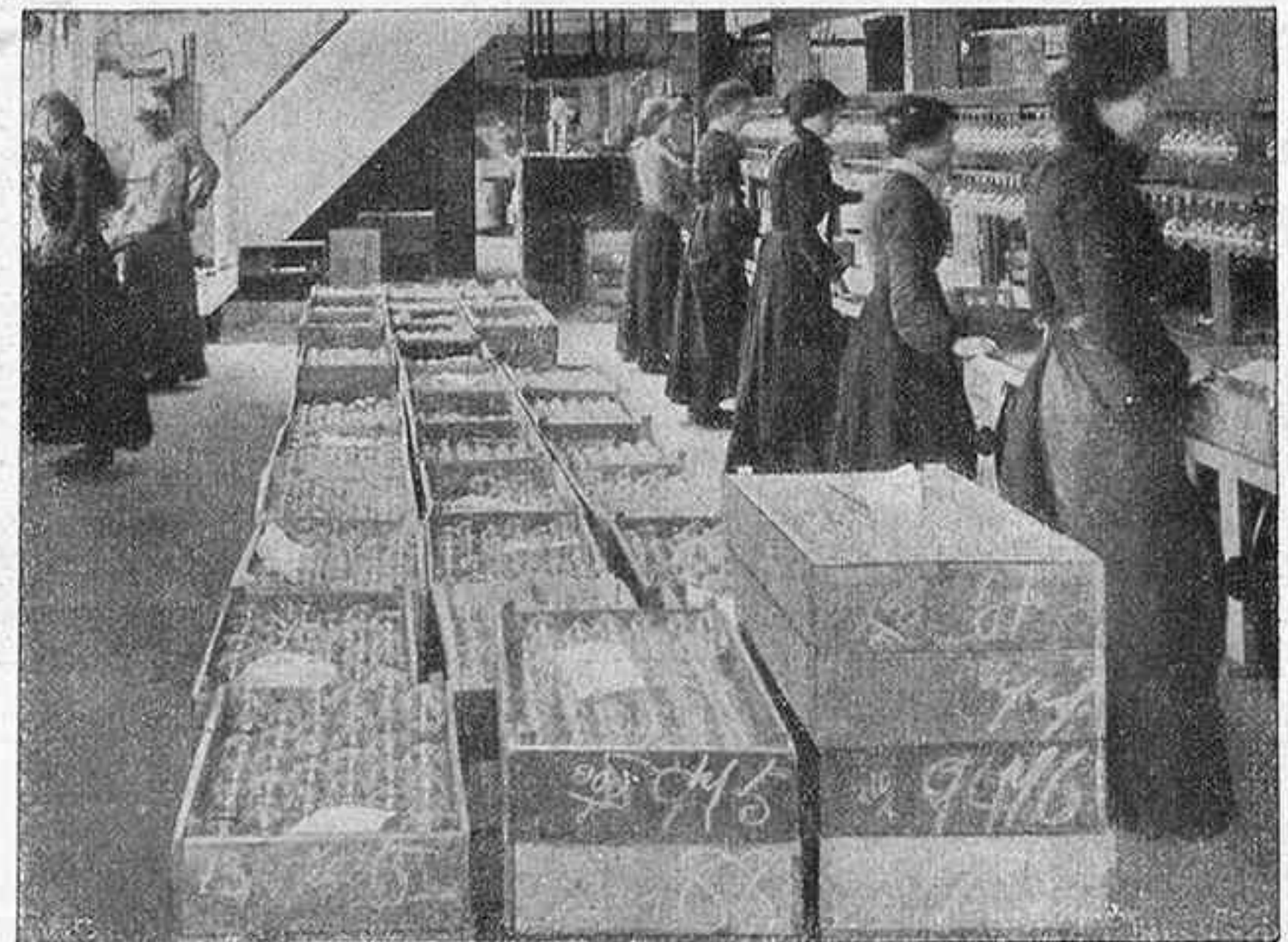
Operación de someter los filamentos á una corriente intensa
