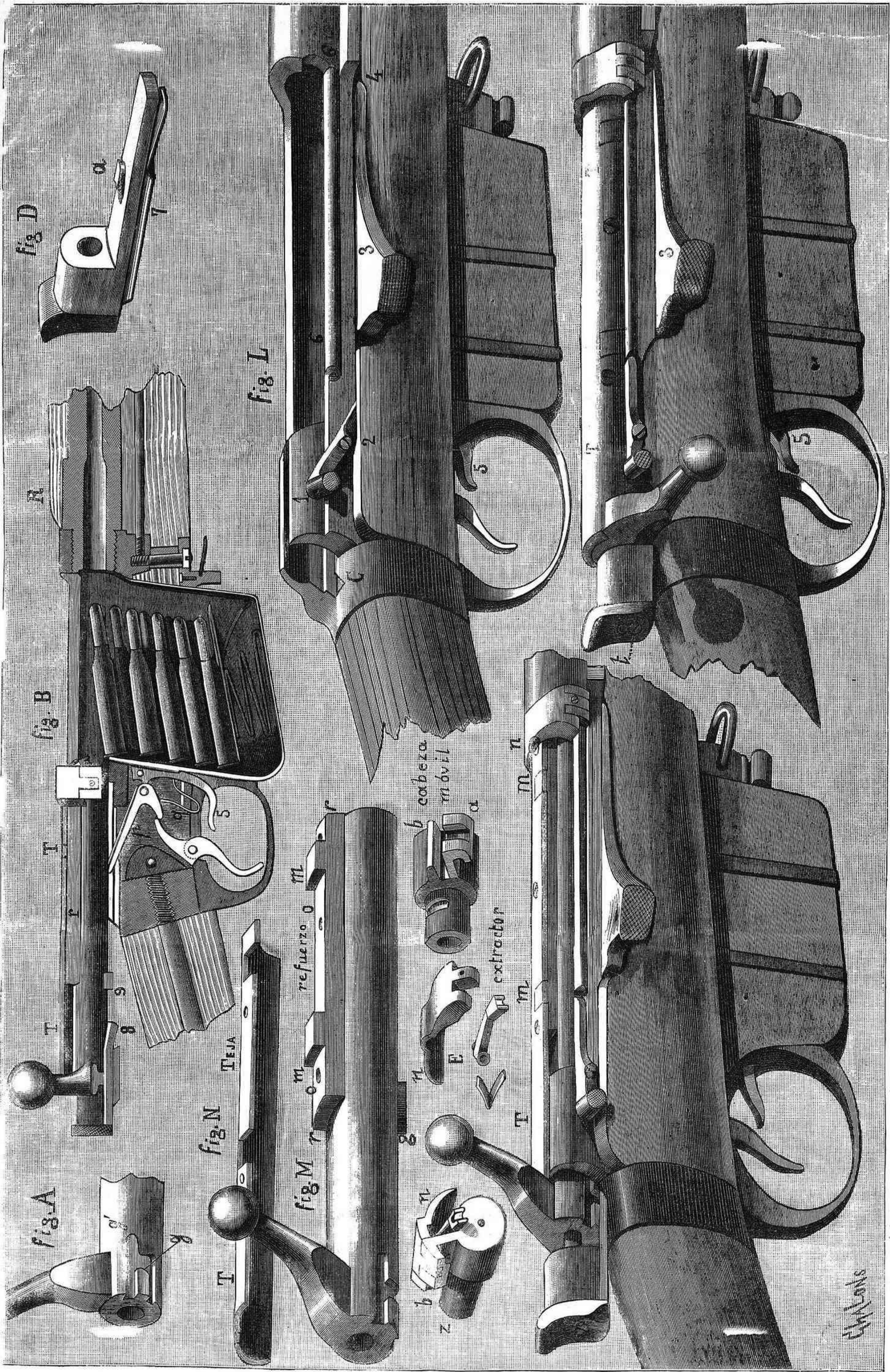
INGLATERRA.—EL FUSIL «LEE-METFORD». M. Cilindro.—D. Percutor.—N. Teja.—A. Parte inferior del cilindro.—B. (p. fador del disparo; 9 muelle; 5 palanca de reteni la del depósito).—I. cajón del mecanismo.
