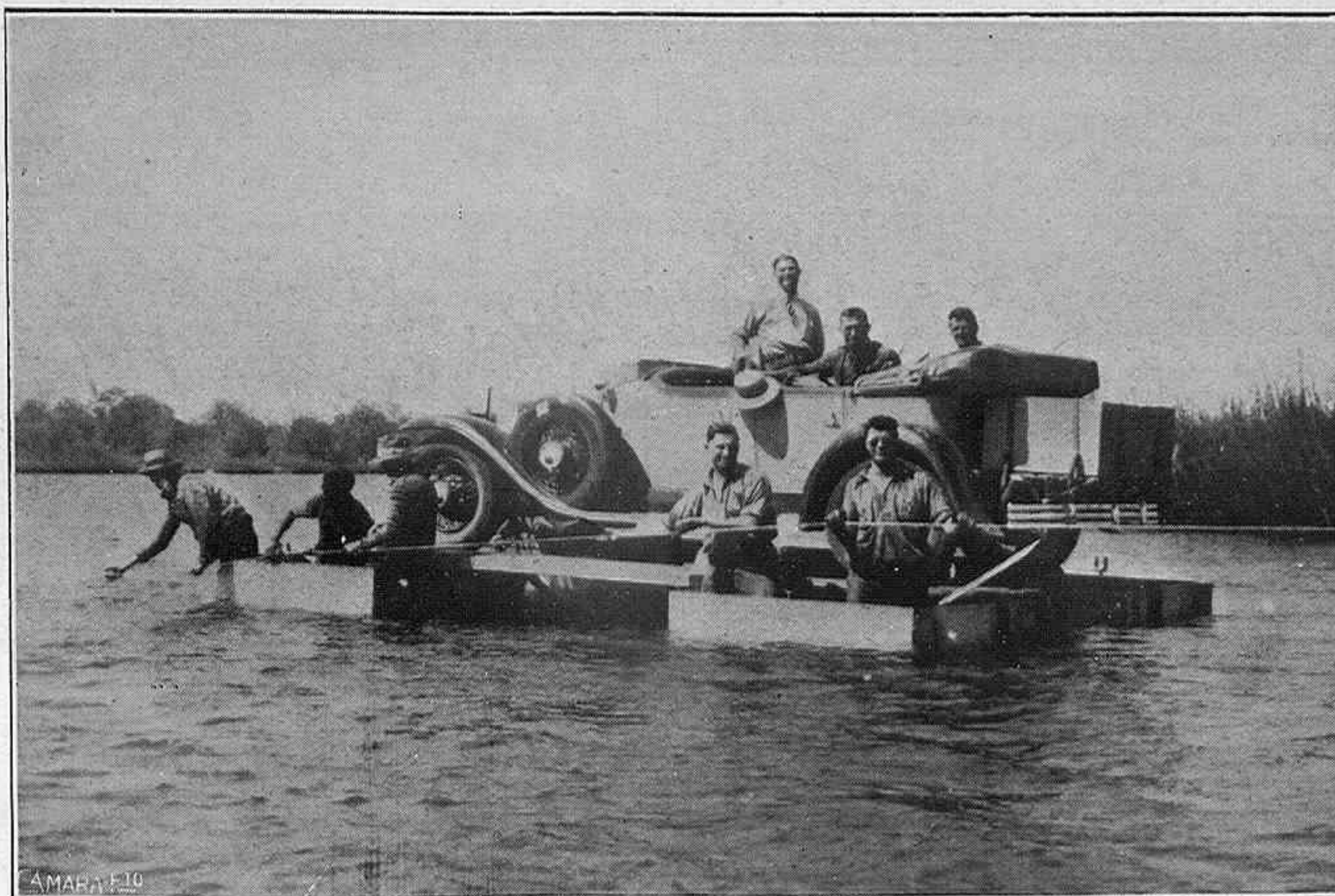
El paso de un río en las colonias inglesas del S. O.—Un automóvil colocado sobre una balsa sostenida por cajas estancos y lleva pendiente un cable tractor
