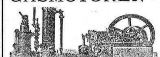
Gasògeno DEUTZ para Gas pobre SIN CALDERA Y ISIN GASÓMETRO
