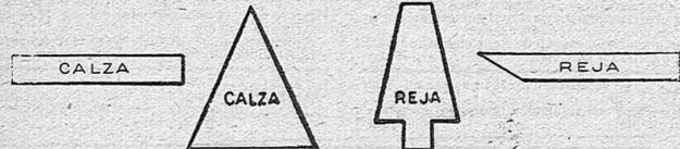
RECORTES Y PLETINAS PARA FABRICACIÓN DE HERRADURAS
