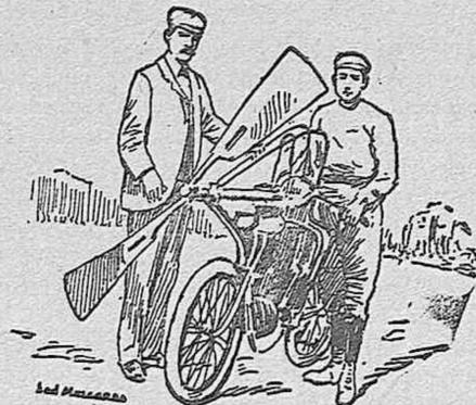
un motor Bouchet, con dos cilindros en V de corazón, y fuerza de seis H. P., el cual acciona por medio de dos poleas, un árbol á cuya extremidad hay fija una hélice, cuyas paletas son de aluminio, de un diámetro de un metro cincuenta. El aparato que en marcha semejaba un monstruo apocalíptico, hizo un recorrido de 79 kilómetros por hora.
