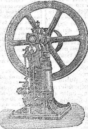
En estos motores se ha suprimido el repartidor efectuándose la entrada de gas y aire por válvulas.
