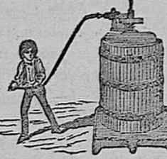
Prensa Hércules, para uvas sistema de palanca múltiple reforzada.
