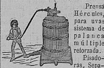
Prensa Hércules, para uvas sistema de palanca múltiple reforzada.
