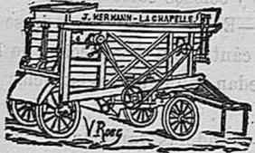
MÁQUINA Á VAPOR y bomba para riego.
