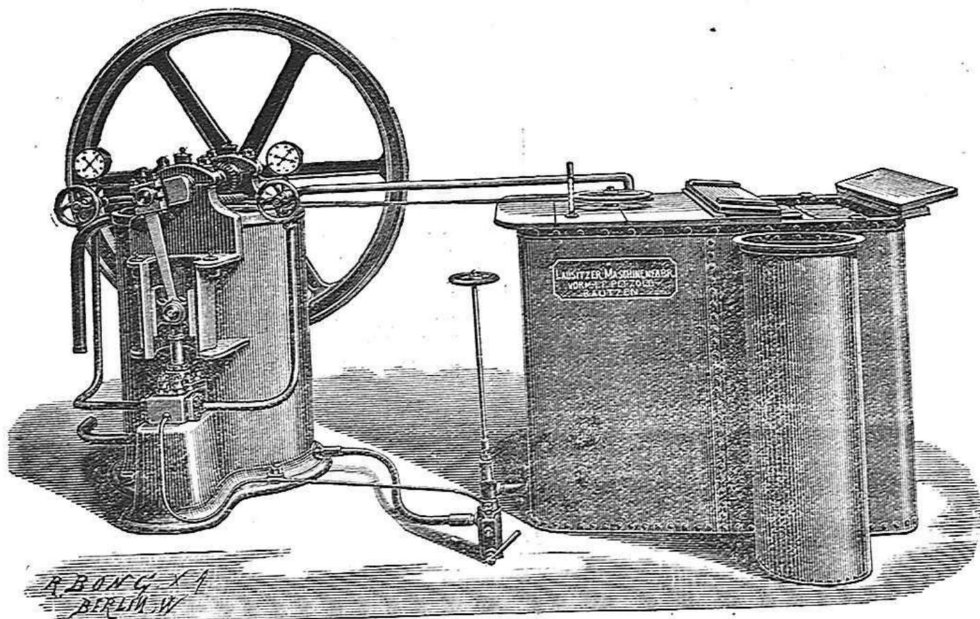
nes consisten en la evaporación de sustancias líquidas y condensación de los respectivos gases mediante una bomba de compresión.
