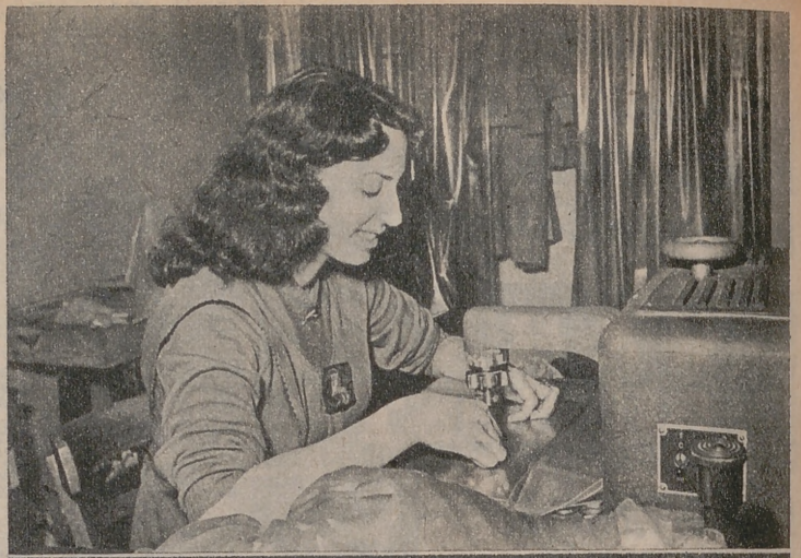
Merceditas Lucas, reciente especialista en la industria de la confección del plástico, suelda electrónicamente las «costuras» de un impermeable
