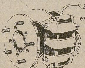
Doble circuito independiente de expansión hidráulica, servo-freno, y frenos de disco en las ruedas delanteras.
