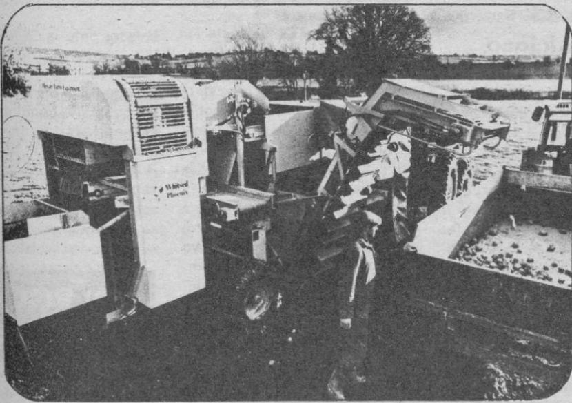
Cosechadora de patata monohilera con equipo clasificador integral de rayos X que cubre 0,3 ha/h. No precisa más que un operario, aparte de los dos conductores de los tractores que tiran de la máquina y el remolque, y proporciona una considerable economía en mano de obra en comparación con los equipos corrientes. La Phoenix trabaja hileras de 71-9 cm. de ancho y
