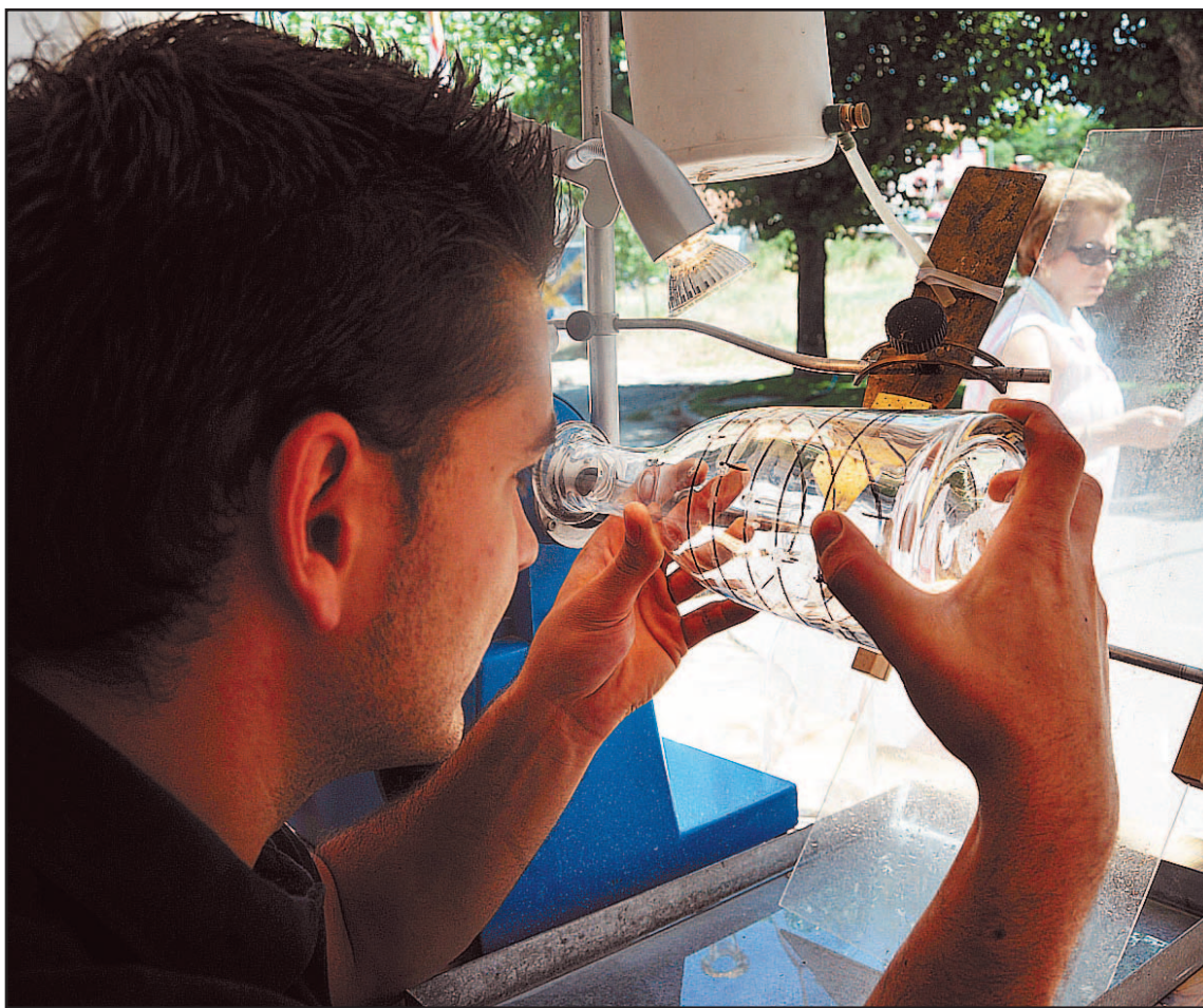
Uno de los trabajadores del Centro Nacional del Vidrio, verificando el perfecto tallado de la pieza
