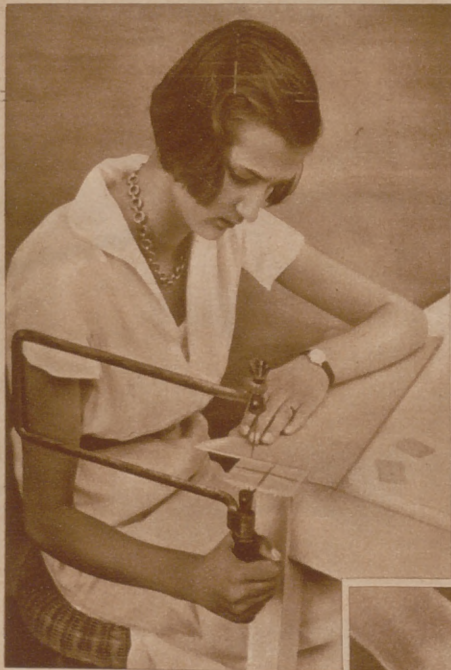
Manera de usar la sierra y la madera para dar forma a los botones
