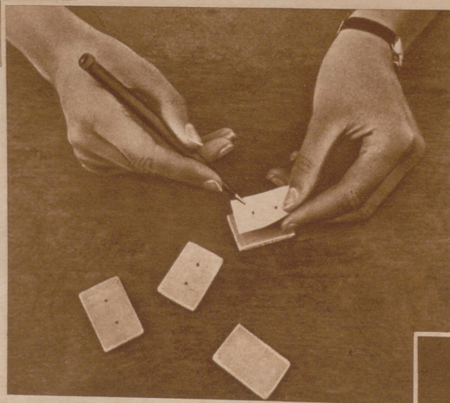
Dibujar los agujeros con un patrón Manera de hacer el taladro para los agujeros
