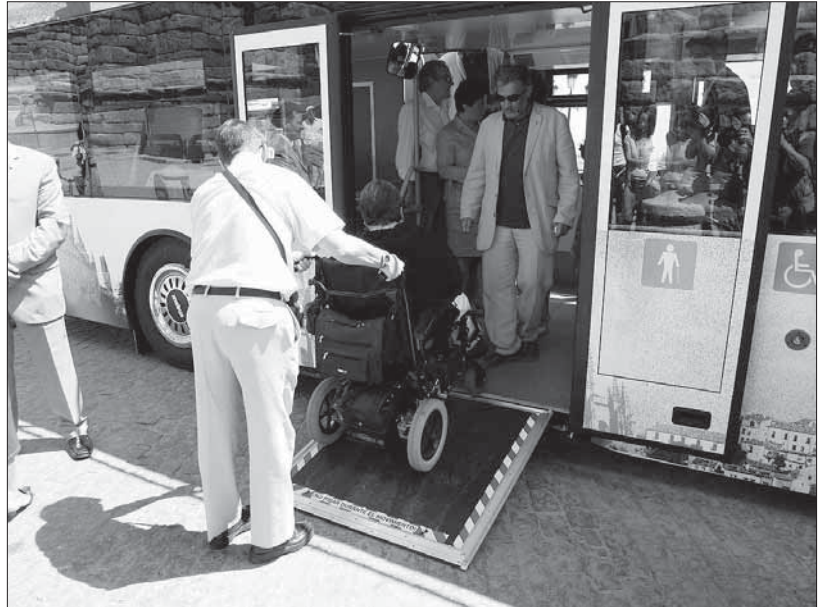
El autobús dispone de una rampa para facilitar el acceso de sillas de ruedas
