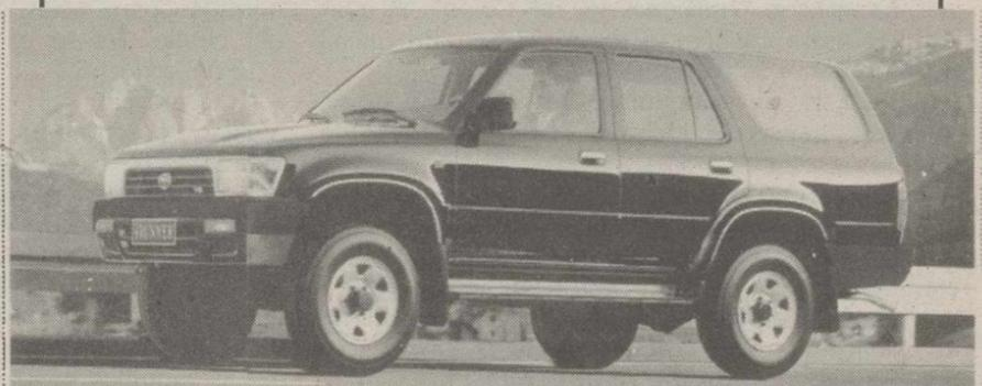
Motorización 3.0 TD. 125 cv - 3.0i V6 - 143 cv.
