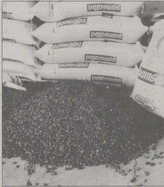
Para la transformación en gránulos, el forraje es deshidratado a 100 grados centígrados.
