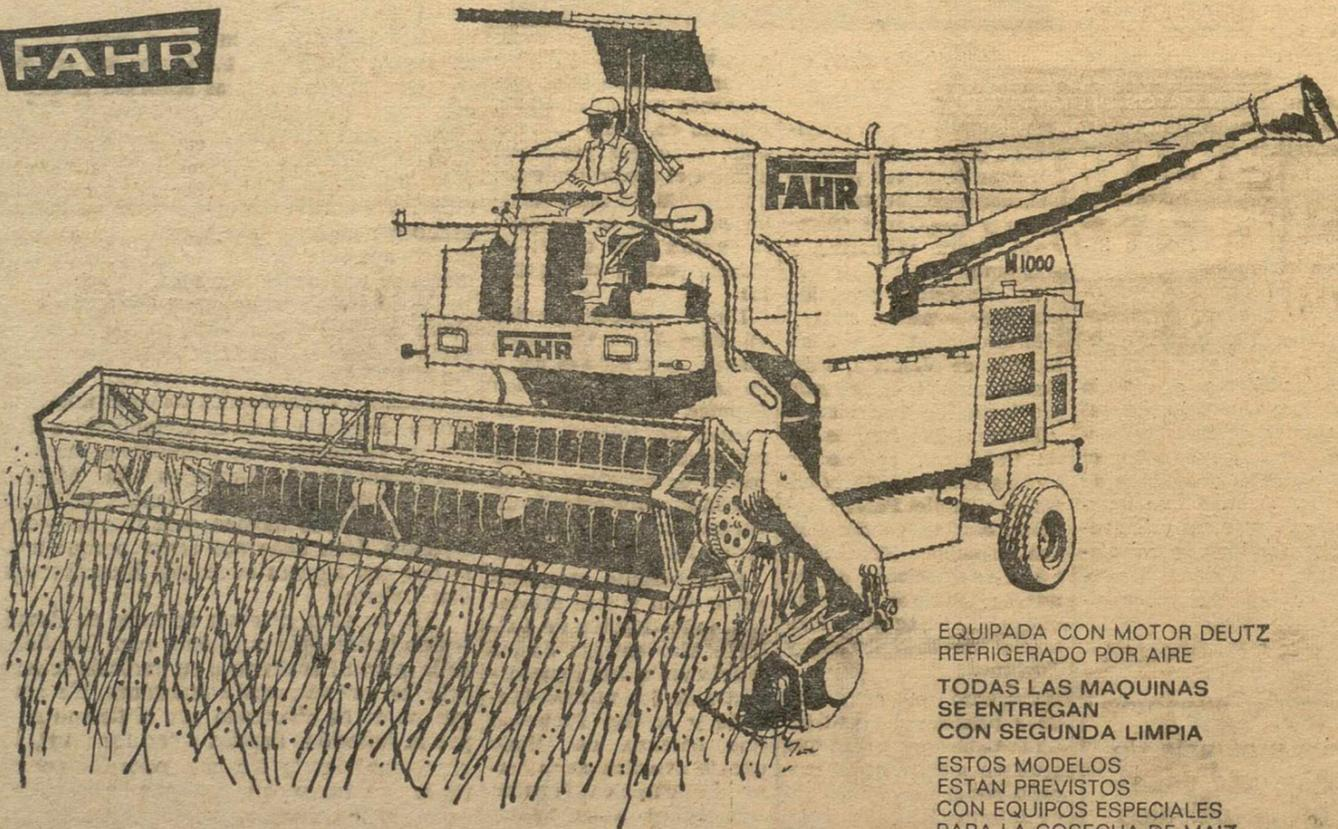
EQUIPADA CON MOTOR DEUTZ REFRIGERADO POR AIRE
