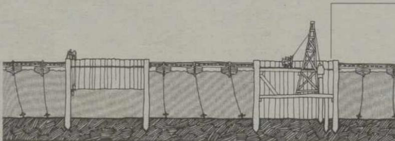
1 COMPARTIMENTOS ESTANCOS. Era necesario crear este tipo de compartimentos para construir los pilones. Una vez que se clavaban firmemente en el lecho del río cilindros de madera permeabilizados se extraía el agua de su interior hasta desecarlos.
