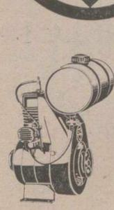
motor refrigerado por aire de 1, 2 y 4 c.v.
