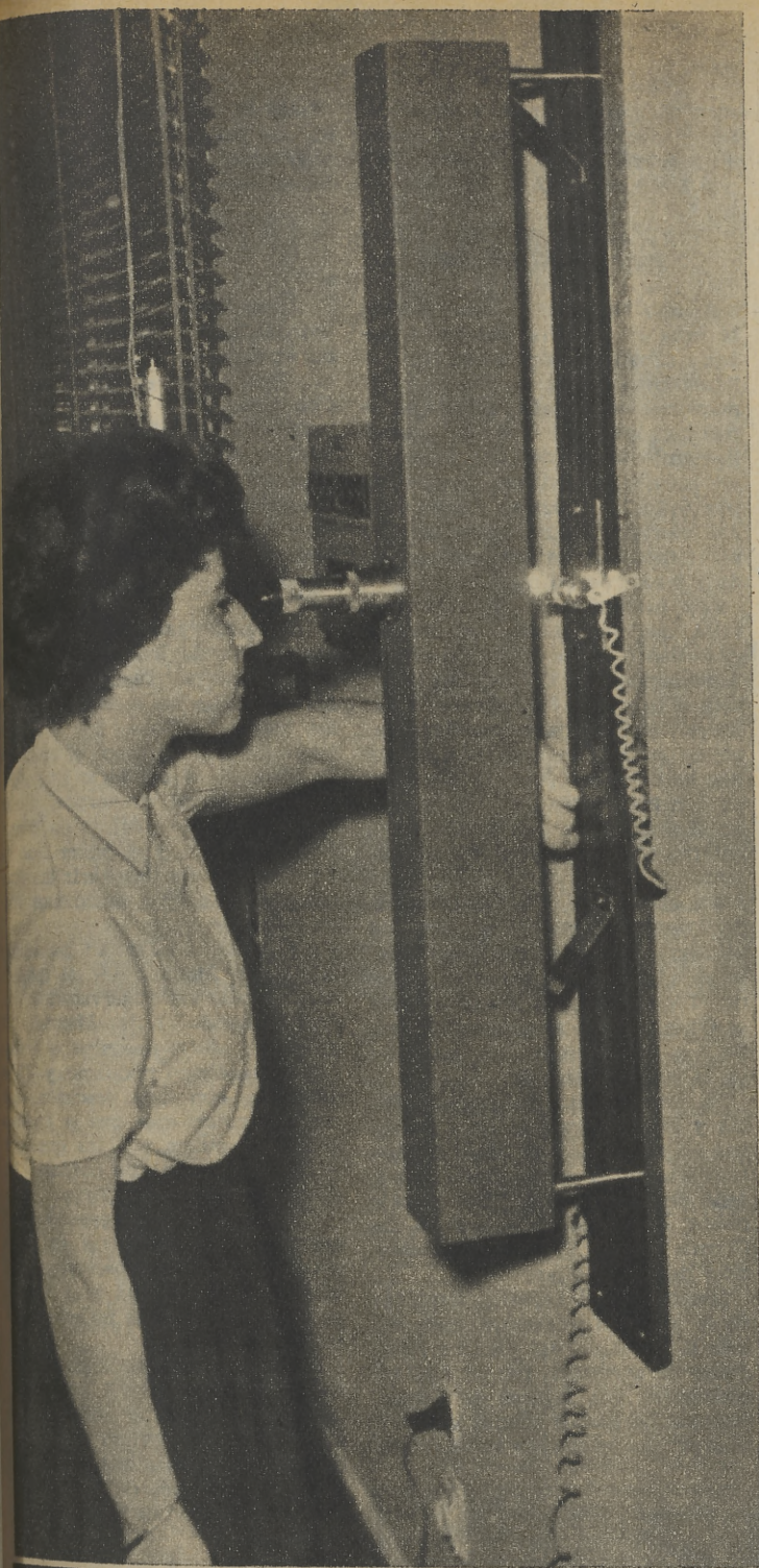
El barómetro absoluto, realización de científicos españoles, construido en el antiguo observatorio meteorológico del Retiro
